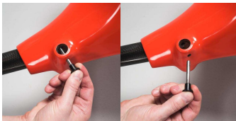
Vytáhneme zajišťovací kolíky ze skeletu dva přední a jeden zadní take out two rear and one front secure pins from the skeleton
